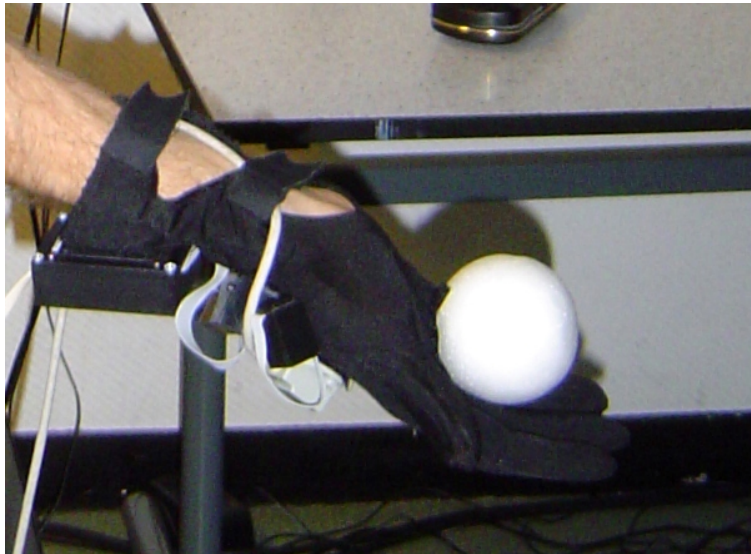
FIG. 3.8 – Dispositif de la balle fixée au gant de données
