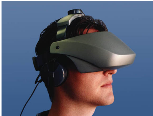
FIG. 1.4 – Un Visiocasque : le 5DT HMD 800 de Fifth Dimension Technologies
