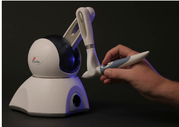
FIG. 1.7 – Un bras articulé à retour d'effort : le Phantom Omni de Sensable
